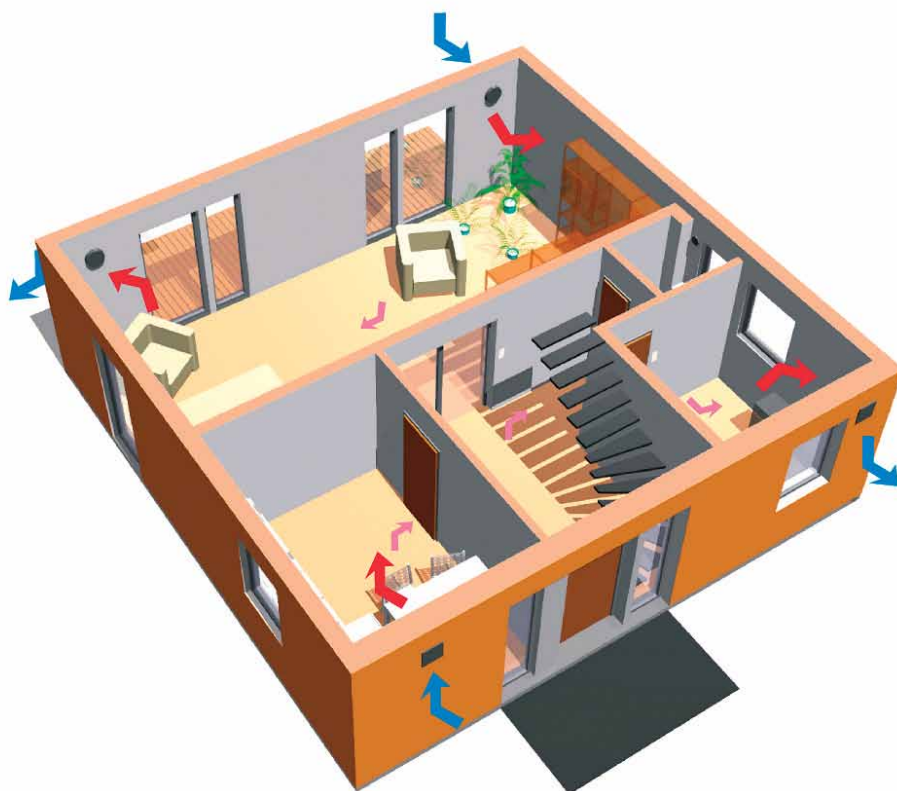
Schéma decentrálneho systému vetrania inVENTer v rodinnom dome
